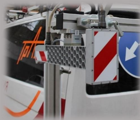
Система поперечной ровности (колейности) покрытия автодорог на основе 2D профилометров
